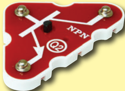
PNP & NPN Transistors (Q1 & Q2)
